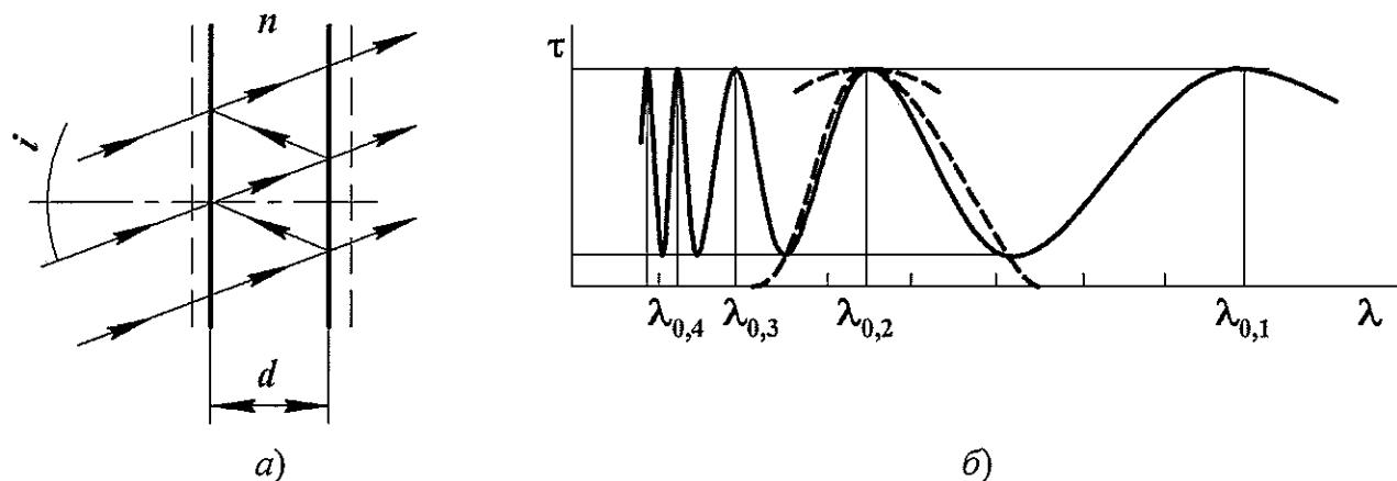
Рис. 9.6. Простейший интерференционный светофильтр:
